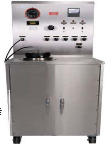
7370 高温高压养护釜
